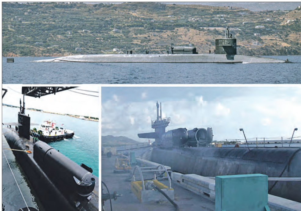
ПЛАРК «Флорида» (SSGN 728) с контейнером-доком для размещения подводных средств доставки «мокрого» типа
