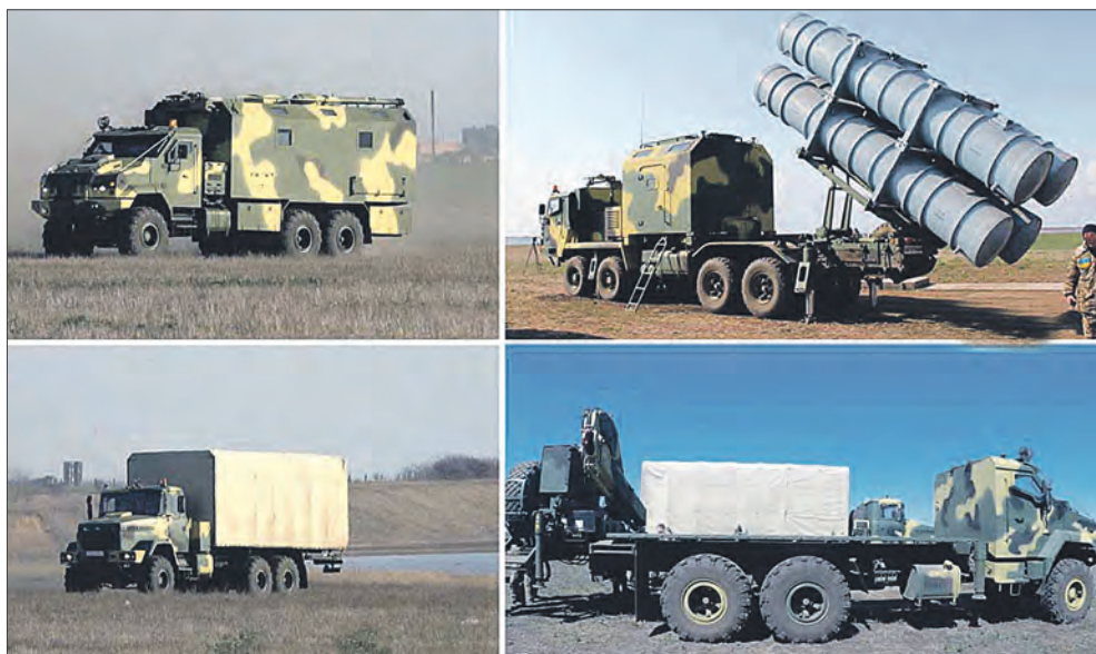
Состав подвижного берегового ракетного комплекса «Нептун» (слева направо, сверху вниз): командный пункт, пусковая установка, транспортная машина, транспортно-заряжающая машина
