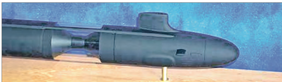
Размещение двухкорпусной секции для ССО
