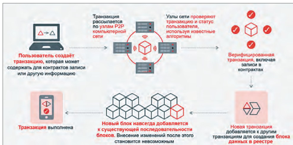
Принцип функционирования технологии «блокчейн»
